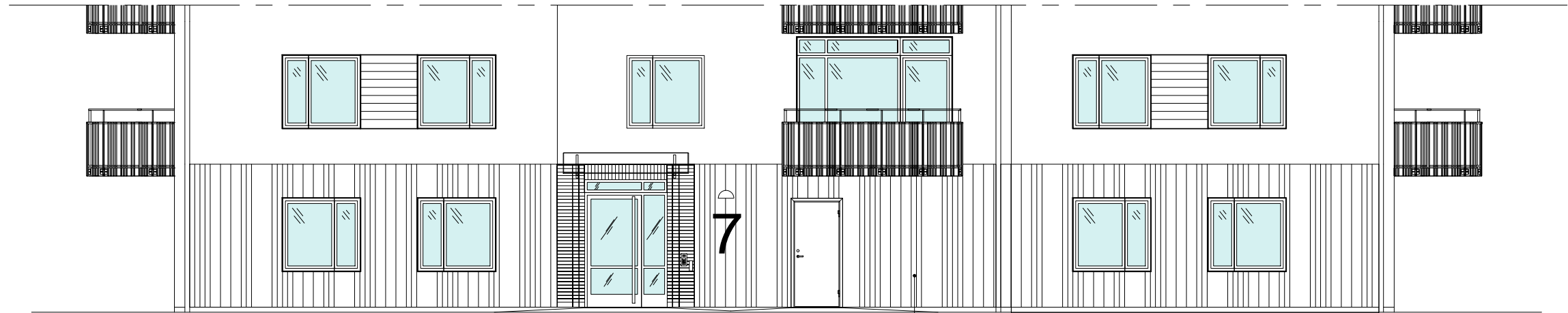
ALTERNATIV FASADUTFORMNING SOCKELVÄNING MÅLAD BETONG MED VERTIKAL MÖNSTERGUTNING
