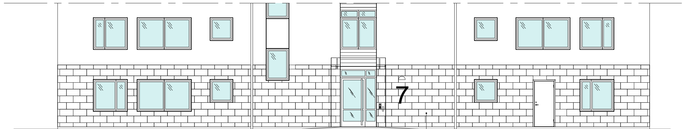
ALTERNATIV FASADUTFORMNING SOCKELVÄNING MED GRANITKERAMIK
